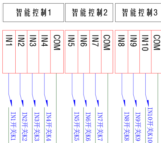
图 4.5 智能控制端口无源开关接线
