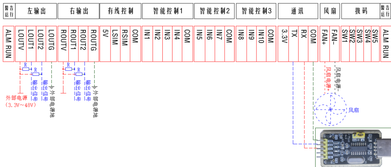
图 5.6 单手航模遥控同源速度闭环控制接线图
