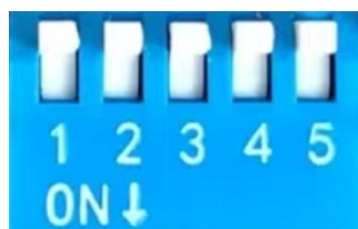
图 5.22 有线摇杆独立速度闭环拨码配置
