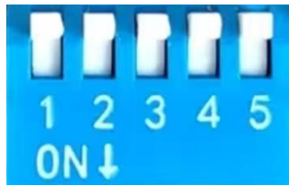
图 5.4 单手航模遥控独立速度闭环拨码配置
