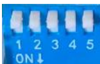
图 5.28 踏板独立速度闭环控制模式拨码配置
