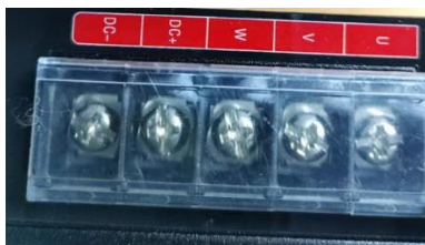
图 3.3 电机接口定义
